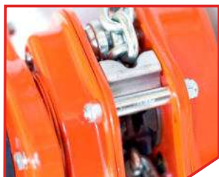
ściągnacz łańcucha umożliwiający bezpieczne prowadzenie łańcucha ładunkowego na lub z krążka ładunkowego bez zaczepiania lub zakleszczania w dowolnej pozycji
